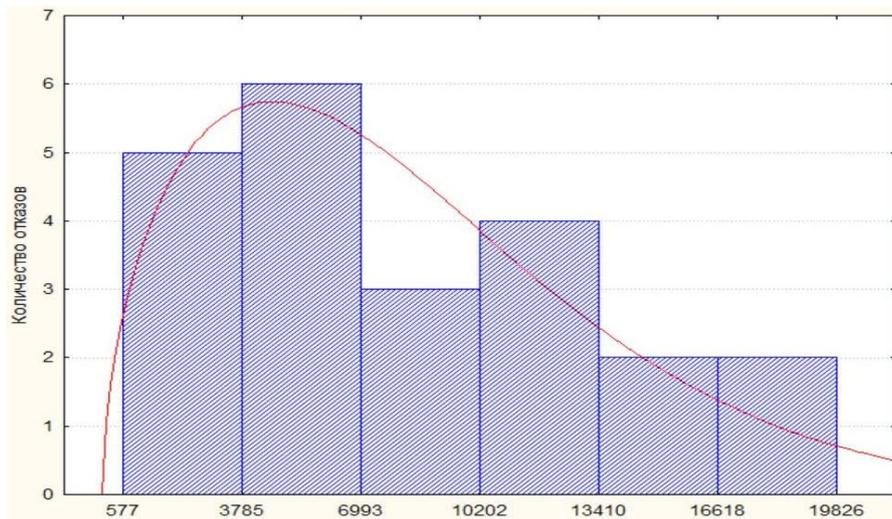
Рис. 4. Гистограмма наработок на отказ гидравлического насоса
