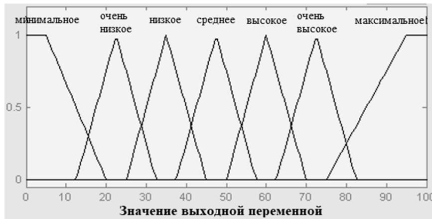
Рис. 4. Выходная функция принадлежности
