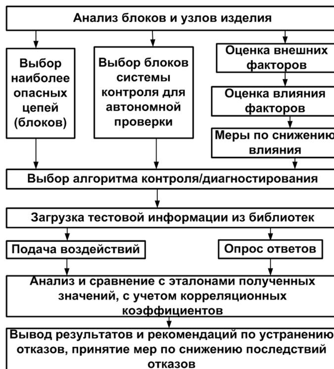
Рис. 3. Структура алгоритма автоматизации процесса диагностирования
