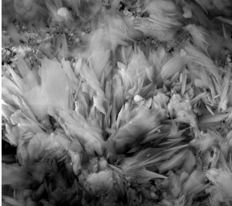
Рис. 2. Растровое изображение чувствительного слоя полупроводникового сенсора с увеличением \times 50000
