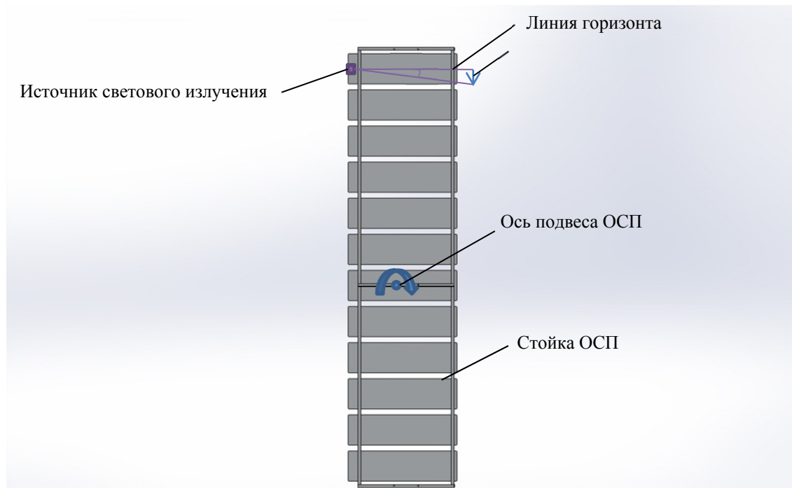
Рис. 4. Смещение светового луча в результате деформации конструкции
