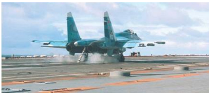
Рис. 1. Зацепление гаком самолета за трос аэрофинишера
