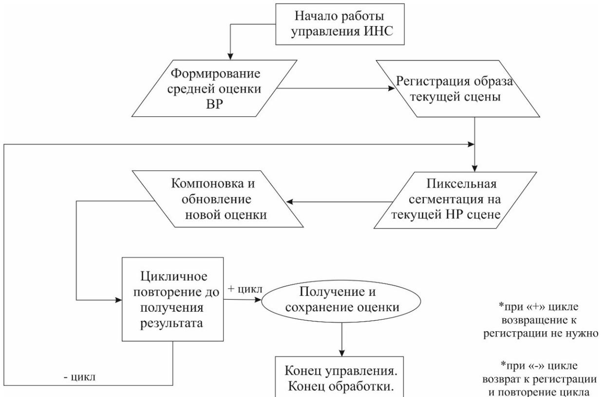
Рис. 2. Новая схема постобработки образов с управлением ИНС
