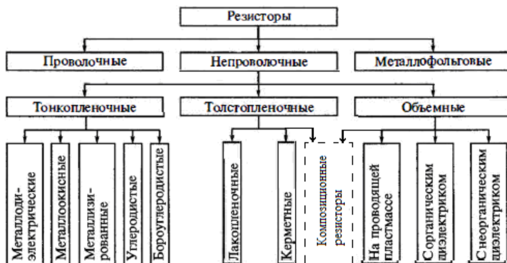
Рис. 1. Классификация резисторов по материалу резистивного элемента
