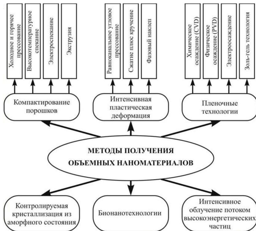
Рис. 1. Классификация методов получения объемных наноматериалов
