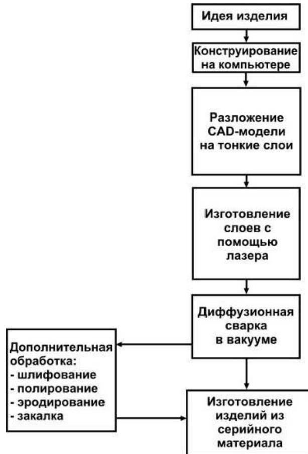
Рис. 4. Алгоритм создания пресс-форм из листовых порошковых материалов
