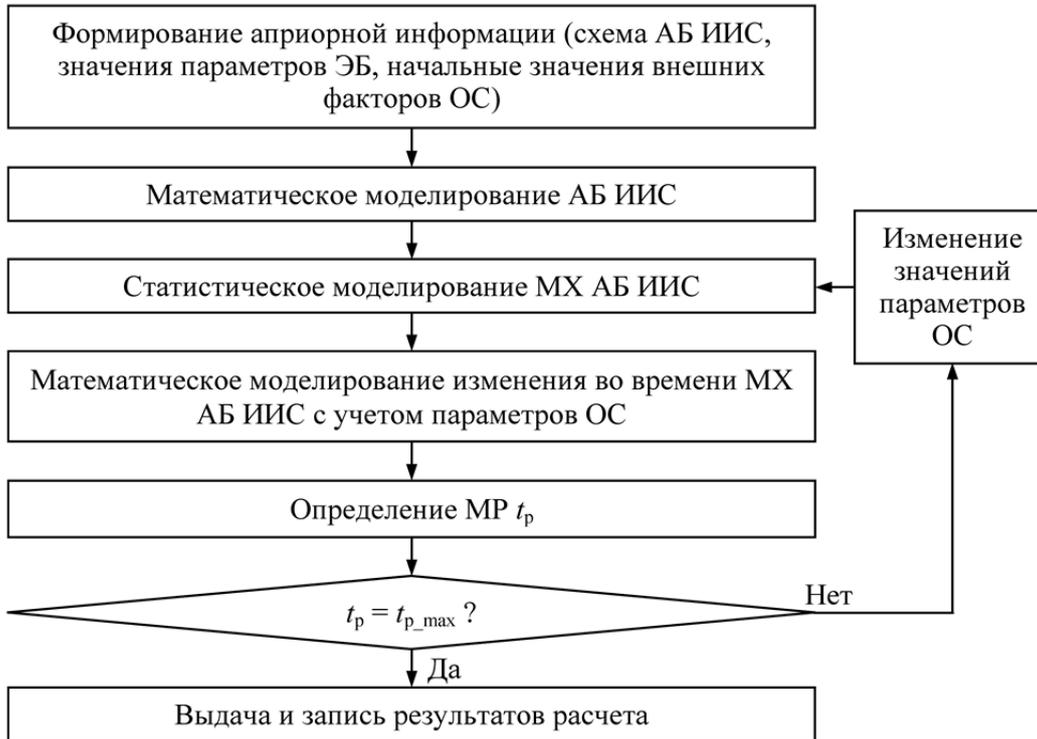
Рис. 1. Алгоритм обеспечения максимального МР АБ ИИС
