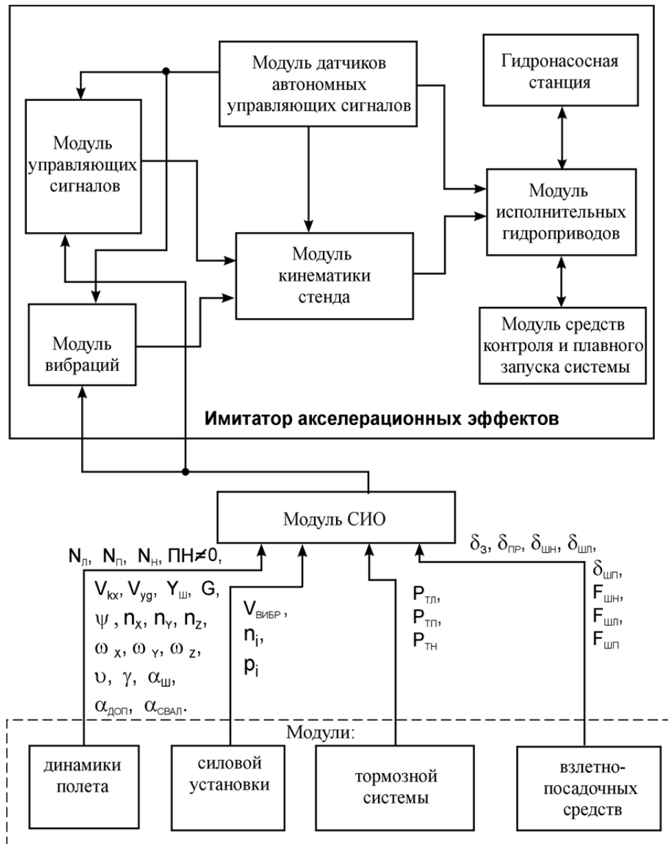
Рис. 5. Структурная схема модуля имитатора акселерационных эффектов
