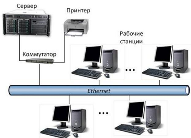
Рис. 1. Схема соединения устройств в ЛВС на базе РС
